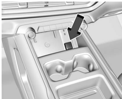
Prise de courant 12 volts de la console centrale
